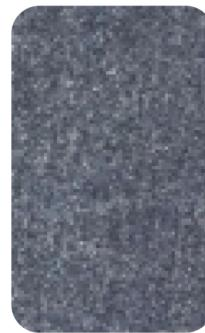
A vászonszövésnek nincs színe vagy fonákja: Mindkét oldal négyzethálós szerkezetű. Kiválóan ellenáll a húzásnak és a kopásnak. Zárt szerkezetű, enyhén deformálható anyag.
